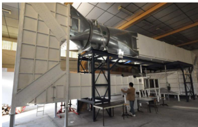
Figure 26 – La soufflerie ISAE pour micro-drone équipée d'un ventilateur à calage variable.
